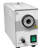
M-OSW-HAL-150-1-XD 301-S Light source XD 301, 150W, jednocanalowe
